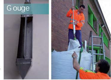
À l'aide d'une gouge qu'on plonge peu à peu dans un big bag, on extrait un à deux kilos de granulats par prises successives de 50 à 200 grammes. Cette quantité est alors réduite à 500 grammes par passages dans un échantillonneur à rifles.
