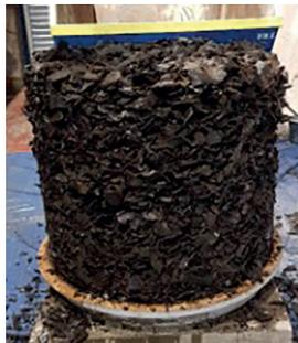
État des plaquettes compactées après le retrait du cylindre. On observe une bonne cohésion des plaquettes, un atout pour une application en remblai derrière un mur de soutènement puisque les plaquettes compactées présentent une très faible poussée due à leur cohésion.
