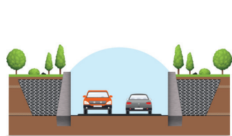
Mur de soutènement
