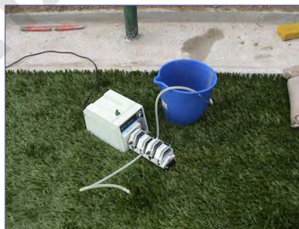
Figure 5 : Système de récupération des percolats collectés dans le lysimètre situé sous le gazon synthétique au moyen d'un tuyau traversant le gazon synthétique et raccordé à une pompe de prélèvement.
