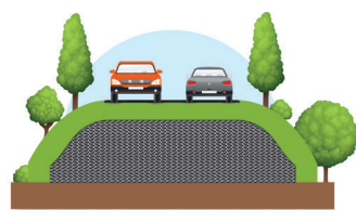
Remblais sous-couche routière
